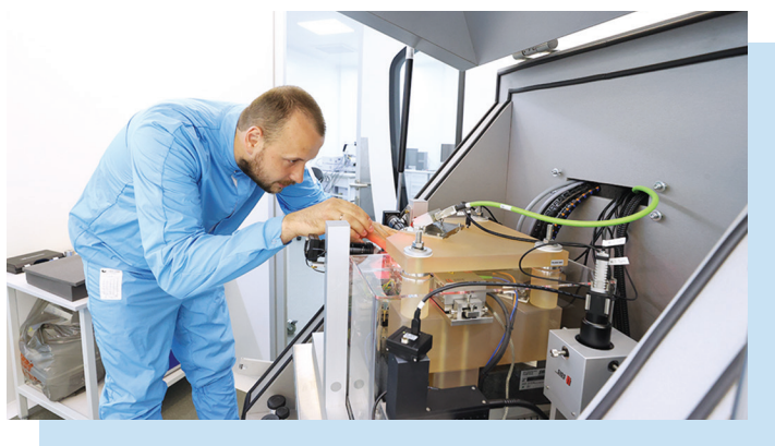
Исследования на национальном эталоне единицы длины в нанометровом диапазоне
