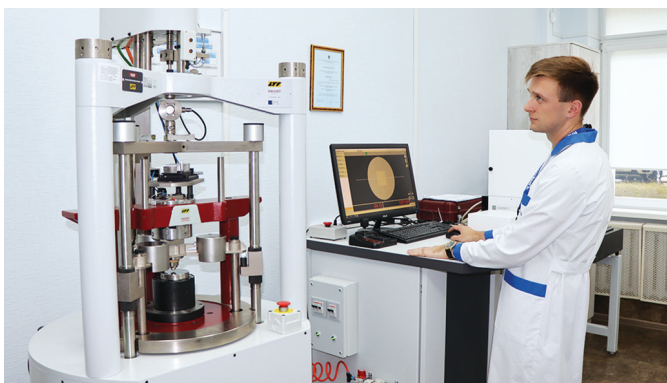
Проведение калибровки на национальном эталоне единиц твердости
