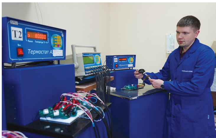
Проверка термометров сопротивления
