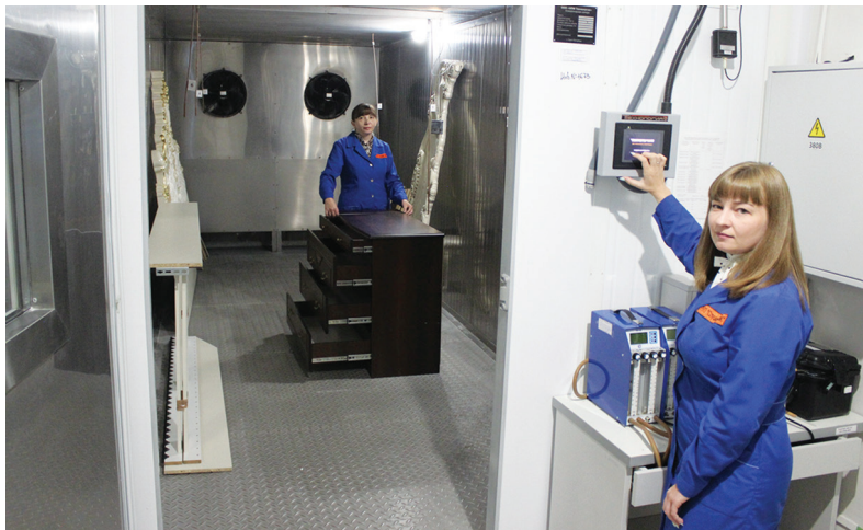
В климатической камере по определению количества вредных летучих веществ, выделяющихся из мебели
